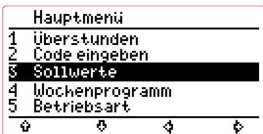
Wählen Sie anschließend den Menüpunkt “3.1.1 Raumtemperatur Tag“ über den „+/-“ Softkey aus:
